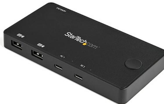
Mit diesem USB-C-KVM mit 2 Ports können Sie ganz einfach zwischen zwei USB-C- oder Thunderbolt3-Desktop- oder Laptop-Computern wechseln, und das mit nur einer Tastatur, einem HDMI-Monitor und einer Maus.
