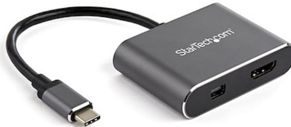
Mit diesem tragbaren USB-C-Multiport-Adapter profitieren Sie von einer tragbaren Lösung, mit der Sie Ihren USB-C-Laptop an ein HDMI- oder Mini-DisplayPort-Display anschließen können. Der Adapter unterstützt High Dynamic Range (HDR) und sorgt für schärfere Bilder mit verbesserter Videoqualität.
