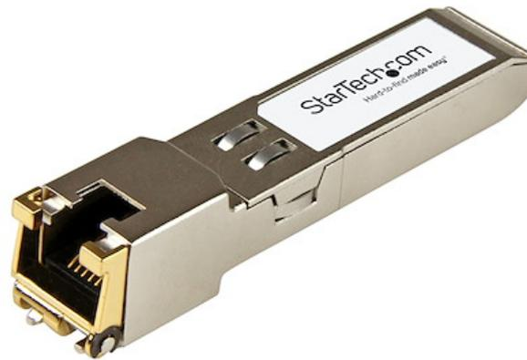
Der PLUS-T-ST ist ein Palo Alto Networks PLUS-T-kompatibles Kupfer SFP+-Transceiver-Modul, das für den Einsatz mit Palo Alto Networks® Marken-Switches und -Routern entwickelt, programmiert und getestet wurde. Es sorgt für zuverlässige 10 GbE-Konnektivität über Kupfer-Kabel für 100/1000/10000BASE-TX-konforme Netzwerke mit einer maximalen Entfernung von bis zu 300m.
