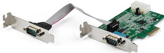
Mit dieser seriellen RS232 Schnittstellenkarte können Sie zwei serielle RS232-Ports (DB9) über einen PCI Express (PCIe)-Steckplatz zu Ihrem Computer hinzufügen. Es ermöglicht die Interaktion mit seriellen Geräten wie Kartenlesegeräten, Druckern, PIN-Pads und Modems mit Geschwindigkeiten von bis zu 921,4 Kbit/s.
