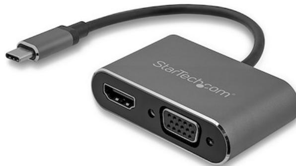
Mit diesem USB-C-auf-VGA-und-HDMI-Adapter profitieren Sie von einer tragbaren Lösung, mit der Sie Ihren USB-C-Laptop an ein VGA- oder HDMI-Display anschließen können. Der Multiport-Videoadapter kann auch als Splitter eingesetzt werden. So können Sie ein identisches Videosignal gleichzeitig an zwei separate Monitore ausgeben (1 x HDMI und 1 x VGA).
