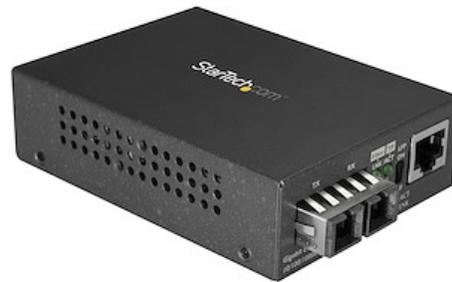
Mit diesem Glasfaser-Medien-Konverter kann ein Gigabit-Ethernet-Netzwerk (1000 Mbit/s) auf eine Entfernung von bis zu 550 m über Multi-Mode-Glasfaser in 1000BASE-SX-Netzwerken erweitert werden.
