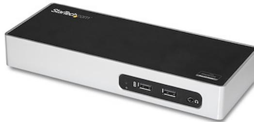
Diese USB 3.0 Docking Station für Mac und Windows™-Laptops bietet Ihnen Flexibilität und die Anschlüsse, die Sie benötigen, um die Leistung der Workstation zu maximieren. Die kostengünstige Dockingstation für zwei Monitore bietet zahlreiche Videoausgabeoptionen, einschließlich HDMI®, DVI und VGA (mit Adapter) und bietet sechs USB-Anschlüsse für Peripheriegeräte, einschließlich zwei Schnelllade-USB-Anschlüsse.
