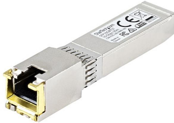
Der SFP10GBTST ist ein MSA-konformer Kupfer-SFP-Transceiver, der speziell für die Arbeit mit 10GBASE-T-kompatiblen Switches und Routern entwickelt, programmiert und getestet wurde. Das SFP+-Transceiver-Modul unterstützt eine maximale Entfernung von bis zu 30 m und bietet eine zuverlässige 10-GbE-Konnektivität über Kupferkabel. Dies ist eine kostengünstige Alternative zu Glasfaserkabeln. **Technische Daten:**
