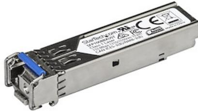
Der SFP100BBXUST ist ein MSA-konformer Upstream-Glasfaser-SFP-Transceiver, der mit dem SFP100BBXDST von StarTech.com gekoppelt werden kann. Sie wurden entwickelt, programmiert und getestet, um mit 100BASE-BX-kompatiblen MSA-Switches und -Routern zu arbeiten. Das SFP-Transceiver-Modul unterstützt eine maximale Entfernung von bis zu 10 km und bietet zuverlässige 1-GbE-Konnektivität über Glasfaserkabel. **Technische Daten:**
