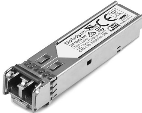
Der SFP1000ZXST ist ein MSA-konformer SFP-Transceiver, der speziell für die Arbeit mit 1000BASE-ZX-kompatiblen MSA-Switches und -Routern entwickelt, programmiert und getestet wurde. Das SFP-Transceiver-Modul unterstützt eine maximale Entfernung von bis zu 80 km und bietet zuverlässige 1-GbE-Konnektivität über Glasfaserkabel. **Technische Daten:**
