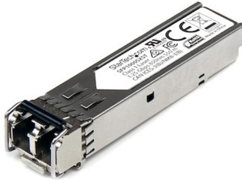
Der SFP1000SXST ist ein MSA-konformer SFP-Transceiver, der speziell für die Arbeit mit 1000BASE-SX-kompatiblen MSA-Switches und -Routern entwickelt, programmiert und getestet wurde. Das SFP-Transceiver-Modul unterstützt eine maximale Entfernung von bis zu 550 m und bietet zuverlässige 1-GbE-Konnektivität über Glasfaserkabel. **Technische Daten:**
