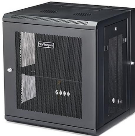
Mit diesem 12HE-Server- oder Netzwerk-Rack-Schrank können Sie Ihre EIA-310-kompatiblen Geräte in einem sicheren Gehäuse an der Wand montieren, das hinten über ein Scharnier für einfachen Zugriff auf Ihre Geräte verfügt. Das Gehäuse erlaubt die Anpassung der Montagetiefe von 5 bis 40,6 cm und ist eine robuste Aufbewahrungslösung für Ihre Rackgeräte.
