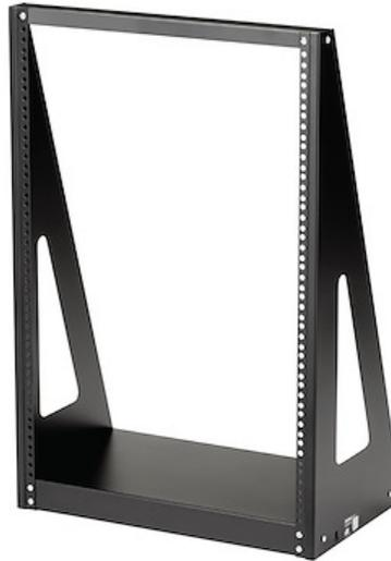
Dieses 2-Pfosten-Rack bietet auf dem Boden oder auf Ihrem Schreibtisch 16 Rackeinheiten für den Einbau EIA-310-D-konformer 19-Zoll-Einbaugeräte, z. B. Telekommunikations- und AV-Systeme. Mit dem Rack schaffen Sie eine robuste Aufbewahrungslösung mit einer Tragkraft von insgesamt 160 kg (350 lb.).
