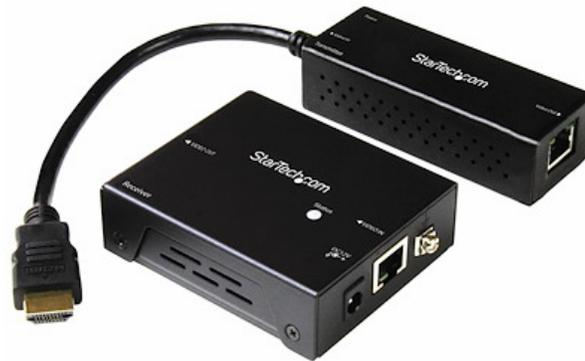
Dieser HDMI-Extender mit 4K überträgt Ihr HDMI-A/V-Signal an einen anderen, bis zu 70 m entfernten Ort.
