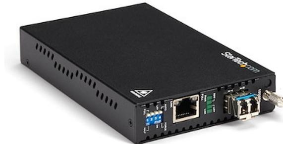
Dieser Gigabit Ethernet-auf-LWL-Medienkonverter ist eine kostengünstige Möglichkeit, Ihr Netzwerk zu erweitern oder die Entfernung zwischen zwei Geräten um bis zu 10 km zu erweitern.
