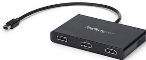
Dank dieses MST-Hubs können Sie drei HDMI-Monitore an Ihren Mini DisplayPort-Computer anschließen. MST funktioniert auf jedem Windows®-Gerät, das DisplayPort 1.2 unterstützt, z. B. Modelle von Lenovo™ ThinkPad® und Microsoft® Surface™. Beim Anschließen an frühere Versionen von DisplayPort, z. B. DP 1.1, dient der MST-Hub als Video-Splitter.
