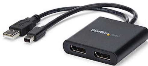
Dank dieses MST-Hubs können Sie zwei DisplayPort-Monitore an Ihren Mini DisplayPort-Computer anschließen. MST funktioniert auf jedem Windows®-Gerät, das DisplayPort 1.2 unterstützt, z. B. Modelle von Lenovo™ ThinkPad® und Microsoft® Surface™. Beim Anschließen an frühere Versionen von DisplayPort, z. B. DP 1.1, dient der MST-Hub als Video-Splitter. Der MST-Hub ist USB-betrieben, sodass Sie für den Betrieb des Hubs lediglich einen Computer benötigen.
