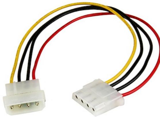
Das Verlängerungskabel LP4POWEXT12 ist mit zwei 4-poligen LP4-Stromanschlüssen (ein Stecker und eine Buchse) ausgestattet und bietet eine Kabellänge von 30 cm, sodass Sie LP4-Stromanschlüsse erweitern und Ihre Geräte (z. B. Festplatte, DVD-ROM-Laufwerk, Zusatzkarte usw.) nach Bedarf innerhalb des Systemgehäuses platzieren können.
