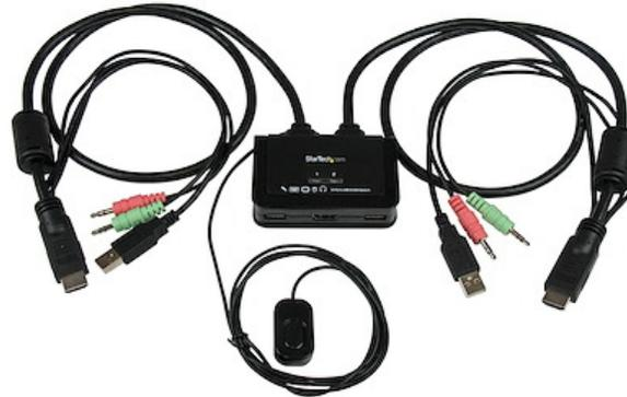
Mit dem 2-Port HDMI® Kabel-KVM-Switch mit Audio und Fernumschaltung SV211HDUA können Sie zwei HDMI-, USB-fähige PCs mit einem einzigen aus Monitor, Tastatur, Maus und Audio-Peripheriegeräten bestehenden Set steuern.
