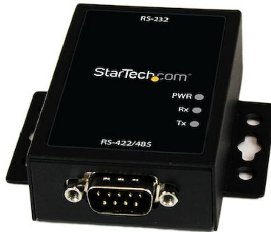
Der industrielle RS232-auf-RS422/485-Seriell-Konverter IC232485S ist ein bidirektionaler Adapter, mit dem Sie ein RS232-Datensignal auf entweder RS485 (2- oder 4-adrig) oder RS422 und umgekehrt konvertieren können. Dabei werden Baudraten von bis zu 921,6 Kbit/s unterstützt.
