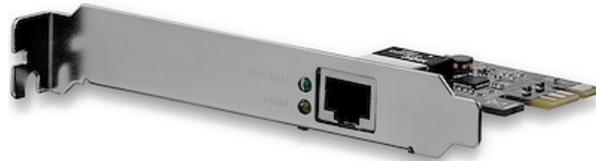
Die PCIe-Gigabit-Ethernet-Netzwerkkarte ST1000SPEX2 ergänzt einen PCI Express-fähigen Client, Server oder Workstation um einen 10/100/1000-Mbit/s-kompatiblen RJ45-Ethernet-Port und bietet somit eine zusätzliche oder Ersatz-Netzwerkschnittstelle.
