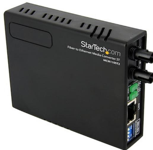
Der MCM110ST2EU 10/100 Multimodus ST Faseroptik-Ethernet-Medienkonverter (2 km) stellt eine kostengünstige Ethernet-Faseroptik-Verbindung her und konvertiert auf transparente Weise auf/von 10Base-T oder 100Base-Tx Ethernetsignale/n und 100Base-Fx optische/n Signale/n, um eine Ethernet-Netzwerkverbindung über eine Multimodus-Faseroptik-Hauptleitung herzustellen.
