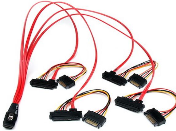
Das SAS808782P50 Mini SAS-auf-SAS-Kabel (50 cm) verfügt über einen 36-poligen SFF-8087-Stecker, der in vier einzelne 29-polige SFF-8482-Buchsen ausläuft und somit eine zuverlässige Lösung zum Anschließen mehrerer SAS HDD-Laufwerke (mit sowohl Daten als auch Stromversorgung) an einen einzigen Mini SAS-Controller-Anschluss ermöglicht.
