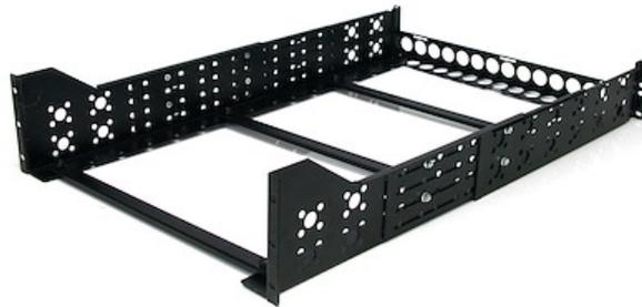
Mit diesen 3U-Server-Rack-Schienen montieren Sie nicht einbaufähige Geräte, wie Desktop-Server, Netzwerkgeräte oder KVM-Switches, in Ihr 19"-Server-Rack, ohne dafür eine zusätzliche Rackeinheit einzubüßen, wie dies bei herkömmlichen Regalen der Fall wäre. Die Rack-Schienen sind zudem eine ausgezeichnete Lösung für die Befestigung von Geräten mit beschädigten Schienen oder abgekündigten OEM-Geräten, wie Dell™-, IBM®-, HP®- oder Apple-Servern, für die keine Rack-Schienen mehr erhältlich sind.
