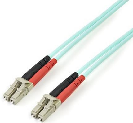
Das 2 Meter lange 10-Gigabit-Aqua-Multimodus-50/125 Duplex LSZH-Faseroptik-Patchkabel A50FBLCLC2 ist an beiden Enden mit LC-Steckern versehen und besteht aus 50/125-Mikron OM3 Aqua-Faseroptik für zuverlässige Datenübertragung mit rasanten Geschwindigkeiten und ist somit perfekt für Faseroptikkabelführungen zwischen verschiedenen Backbone-Switches, Hubs und Routern ebenso wie High End-Netzwerkgeräten geeignet.
