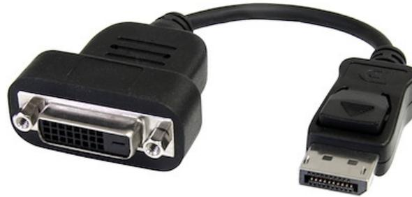
Mit dem DisplayPort auf DVI-D Active Single Link-Adapter DP2DVIS können Sie Ihre DisplayPort-Videoquelle (z. B. Desktop-PC, Laptop usw.) an jeden DVI-D-Monitor, Projektor oder Display, einschließlich Fernsehgeräte und Apple Cinema Display HD, anschließen und sparen so die Kosten für die Aufrüstung auf einen DisplayPort-fähigen Monitor.
