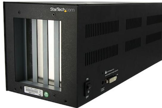
Das PCI/PCI Express-Erweiterungsgehäuse PEX2PCIE4L ist eine schnelle und einfache E/A-Erweiterungslösung für fast jedes PCI Express (PCIe)-fähige System. Das Hinzufügen von PCI/PCIe-Karten zu einem Server oder einer Workstation oder die Bereitstellung einer Plattform zum Wechseln von Karten zwischen Mobil- und Desktop-Konfiguration ist eine kostengünstige und zeitsparende Lösung für die Optimierung der E/A-Kapazitäten Ihres Systems.
