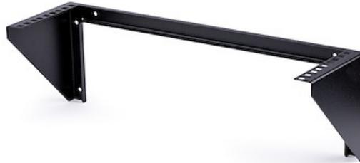
Dieses 3HE 19 Zoll Rack für Serverräume ermöglicht die vertikale Montage von Rack Geräten mit beliebiger Tiefe. Montieren Sie die Halterung an einer Holzbohlenwand und positionieren Sie die Geräte vertikal, um die Raumnutzung zu steigern und das Layout zu verbessern. Die Open-Frame Konstruktion ermöglicht einen ungehinderten Luftstrom zu den montierten Geräten und verbessert die Kühlung.
