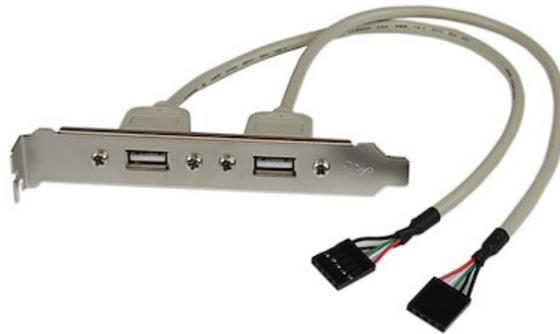
Das 2-Port-USB A-Slotblech USBPLATE konvertiert die USB-Pole der meisten AT-Pentium-Hauptplatinen (und neueren) in 2 standardmäßige USB A-Ports. Das Blech kann an die Rückseite eines Computergehäuses montiert werden. So werden zwei USB A-Buchsen zum einfachen Anschließen von USB-Peripheriegeräten hinzugefügt.
