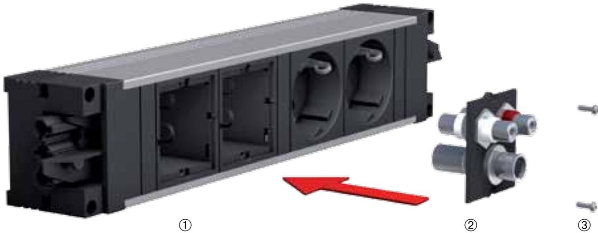
In den leeren Einbaurahmen<sup>①</sup> der Bachmann Facility Systeme werden die Custom Module<sup>②</sup> eingeschraubt und mit zwei Torx Schrauben<sup>③</sup> fixiert. Durch Lösen der Schrauben können die Custom Module einfach ausgetauscht werden.
