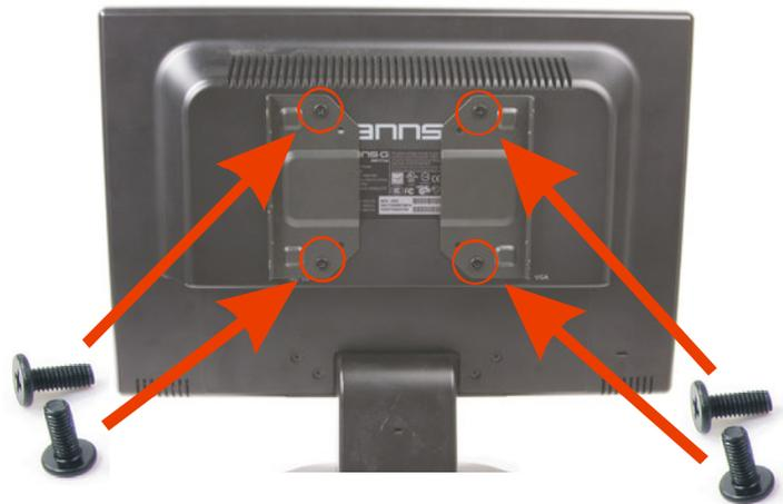
(3) Setzen Sie den XPC slim in den VESA-Halter und richten Sie ihn so aus, dass die Schraublöcher zusammenpassen. Dann befestigen Sie ihn von beiden Seiten mit Rändelschrauben.
