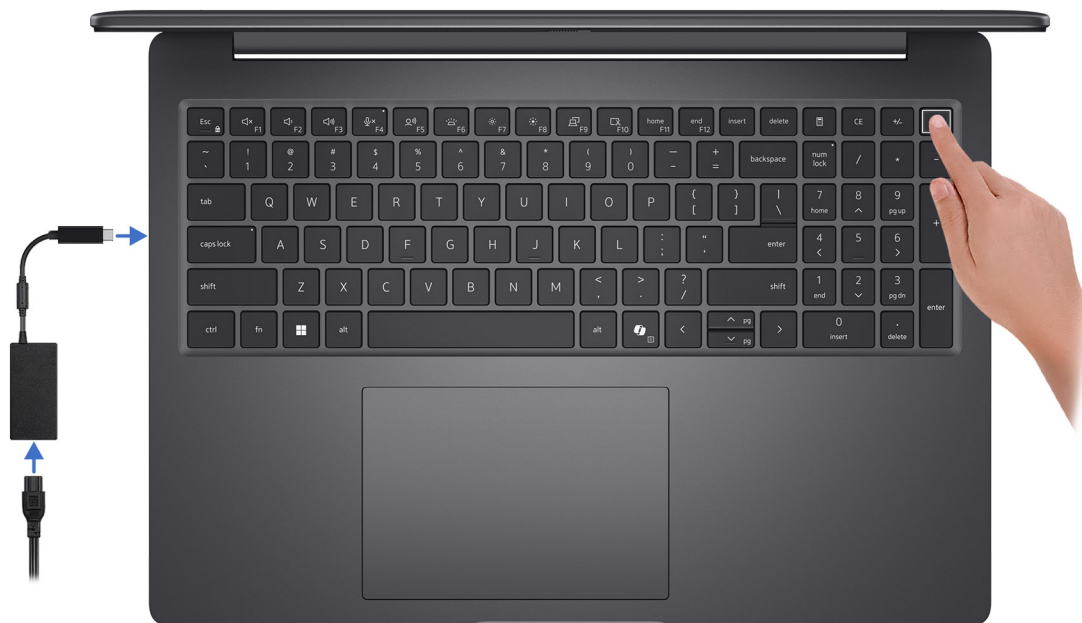
Abbildung 7. Anschließen des Netzteils und Drücken des Netzschalters
