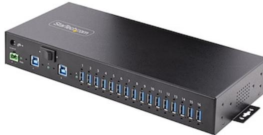
Der 16-Port industrielle USB 5Gbps Hub mit Stromadapter verfügt über 16 Downstream USB-A Ports. Die robuste Ganzmetallkonstruktion ist für den Einsatz in industriellen Rackmount-Anwendungen geeignet. Der Level-4 Schutz vor elektrostatischer Entladung (ESD) schützt vor 15kV Luft / 8kV Kontaktentladungen. Der Hub verfügt über einen 2-Port Host Switch, mit dem der Benutzer zwischen zwei Host-Geräten umschalten kann.
