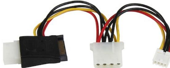
Dieses LP4-auf-SATA-Netzadapterkabel verfügt über eine LP4-Buchse sowie eine SP4-Stromversorgungsbuchse und einen SATA-Stromversorgungsstecker zum Anschließen einer IDE-Festplatte sowie eines Floppy-Disk-Laufwerks an einen seriellen ATA-Stromanschluss der Computer-Stromversorgung. Dieses hochwertige LP4/SATA-Netzadapterkabel wurde für seine Langlebigkeit entworfen.
