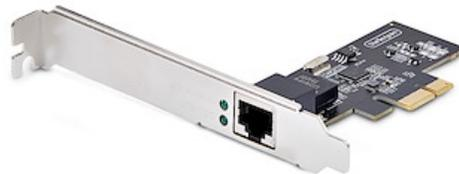
Diese 2,5 GbE Netzwerkkarte (NIC) verfügt über einen Intel I225-V Chipsatz mit Intel vPro Technologie, um die Leistung und Datenintegrität zu verbessern. Variable Multispeed-Optionen (2,5/1Gbps und 100/10Mbps) ermöglichen die Unterstützung sowohl neuer als auch älterer Netzwerkhardware. Nutzen Sie die vorhandene Cat5e- oder CAT6-Verkabelungsinfrastruktur und fügen Sie gleichzeitig NBASE-T (802.3bz) Kompatibilität für eine nahtlose Integration hinzu.
