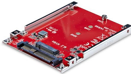
Konvertieren und verbinden Sie ein PCIe M.2 NVMe/AHCI SSD mit einem 2,5 Zoll Formfaktor, um es in einem U.3-Laufwerksschacht oder einer Backplane zu installieren.
