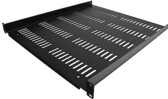
Mit dem SHELF-1U-20-FIXED-V können Sie jedes EIA-310 konforme 19 Zoll Netzwerk oder Server Schrank um ein 1HE 50 cm tiefes perforiertes Fachboden erweitern. Der Fachboden ist perforiert, um die Luftzirkulation zu verbessern und die Temperaturen in Ihrem Rack zu senken.
