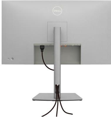
Nach Anschluss aller erforderlichen Kabel an Ihren Monitor und Computer (siehe Ihren **Monitor anschließen** zum Kabelanschluss), organisieren Sie alle Kabel wie oben dargestellt.
