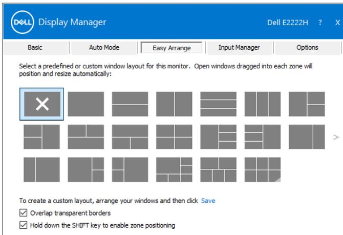
Wenn Sie mehrere Monitore in einem Array oder einer Matrix nutzen, kann das **Easy Arrange**-Layout auf alle Monitore als ein Desktop angewandt werden. Wählen Sie zur Aktivierung dieser Funktion „**Mehrere Monitore umspannen**“. Zur effektiven Nutzung müssen Sie Ihre Monitore richtig ausrichten.
