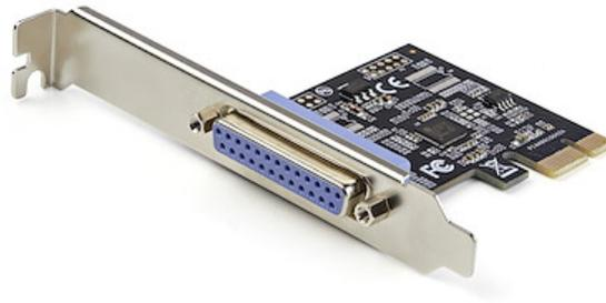
Diese parallele PCIe-Schnittstellenkarte wird in einen verfügbaren PCI-Express x1-Steckplatz Ihres Computers eingesetzt und ermöglicht Ihnen, Ihrem System einen parallelen DB25-Kommunikationsanschluss hinzuzufügen.
