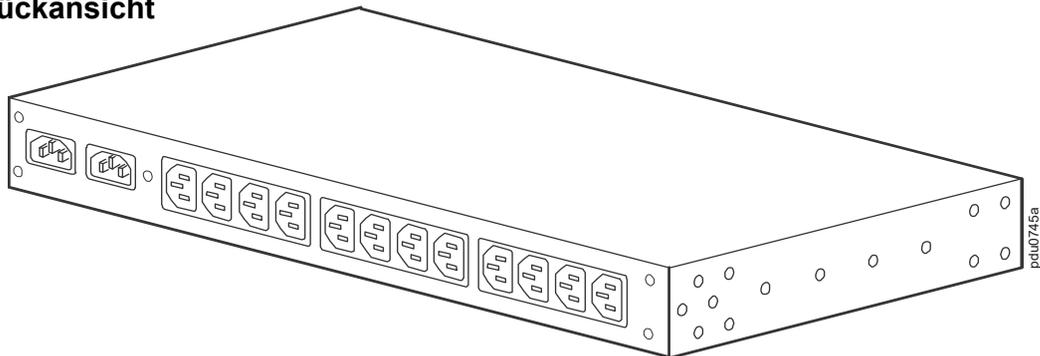
**Netz-Eingänge:** An den beiden (2) C14-Netz-Eingängen können zwei Stromkabel (nicht im Lieferumfang enthalten) angeschlossen werden, um den ATS mit zwei unterschiedlichen Stromquellen (A, B) zu verbinden. Der Switch bezieht Strom aus einer Primär-Stromquelle und wechselt gegebenenfalls auf eine Sekundär-Stromquelle.
